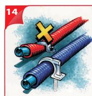
Con l'eccezione dei sistemi di riscaldamento/raffrescamento a pavimento, fissare il tubo al pavimento senza danneggiare la guaina o il tubo stesso.
