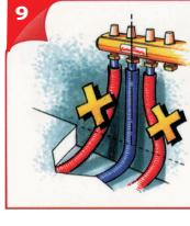
Per ottenere una connessione del tubo alle apparecchiature (per esempio collettori) è importante posare il tubo con la corretta angolazione.
